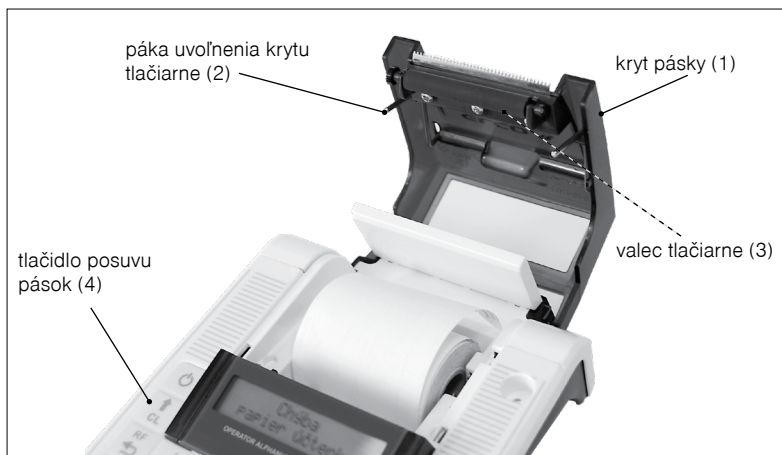
Obrázok 2.6 – Zavedenie papierovej termo pásky do tlačiarne pokladnice
